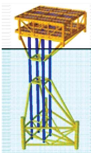
Hình 8. Mô hình chân đế sử dụng ống dẫn (supported conductors) để cố định
