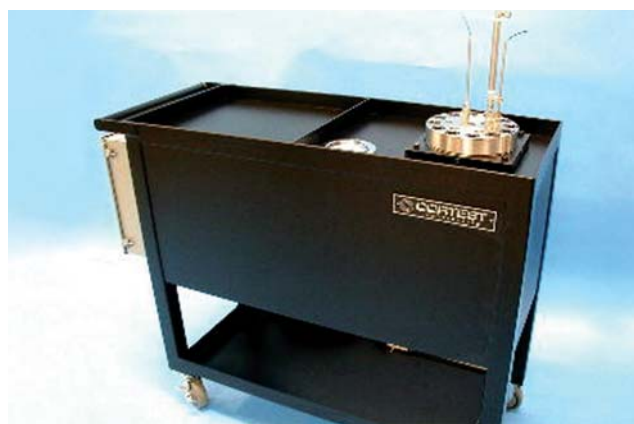
Hình 2. Hệ thiết bị Autoclave thử nghiệm ăn mòn trong điều kiện áp cao nhiệt cao
